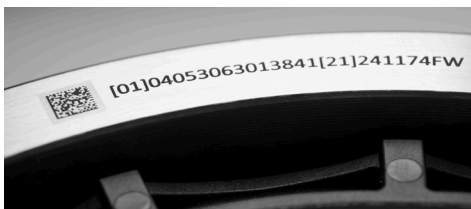
Abbildung 8: Anwendungsbeispiel einer serialisierten GTIN, welche in einem GS1 DataMatrix per Direktmarkierung – hier gelasert – auf ein aufbereitetes Wälzlager der Firma HFG aufgebracht wurde
